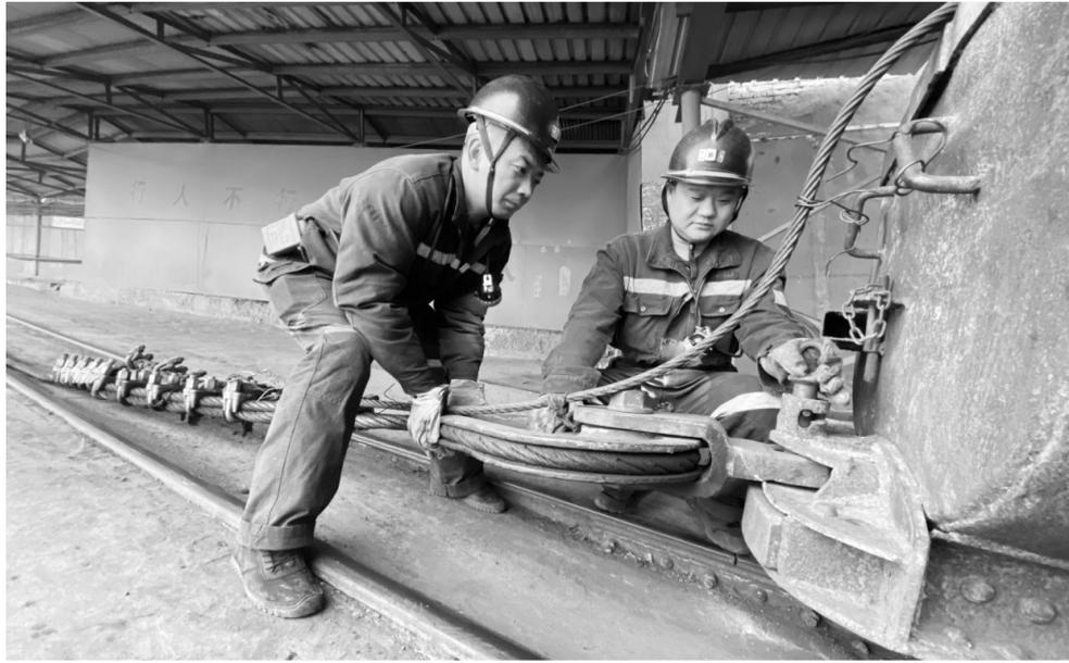
近日,华阳集团二矿全面加强安全隐患排查治理力度,对影响安全生产的因素,进行超前预警,超前部署、查漏补缺,确保矿井安全生产。图为岗位工正在对矿车的连接装置进行检查。任长生 摄
