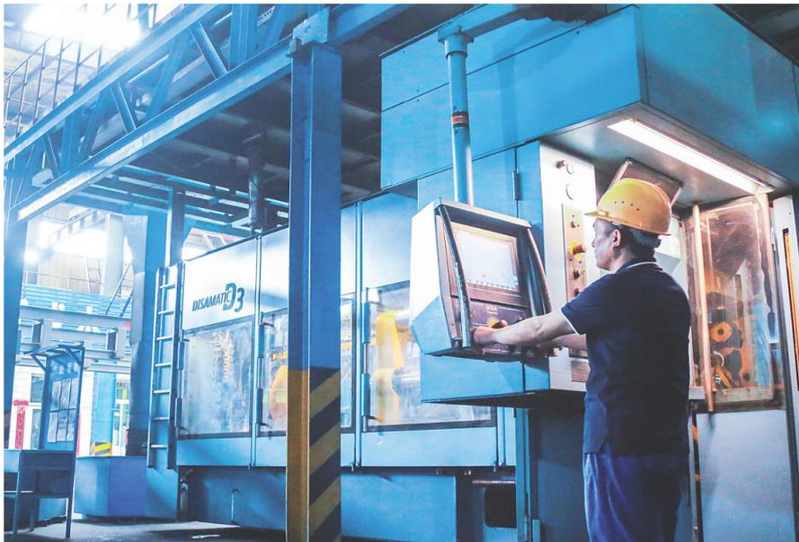
在卡耐夫集团(山西)管道系统有限公司生产车间,技术人员正在使用丹麦进口迪沙全自动造型线加工产品。 本报记者 郝光明 摄
